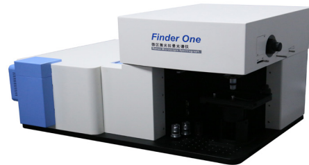
图1 Finder One 微区激光拉曼光谱仪
